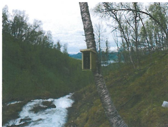
Vannføringskamera som tar bilder en gang i timen
