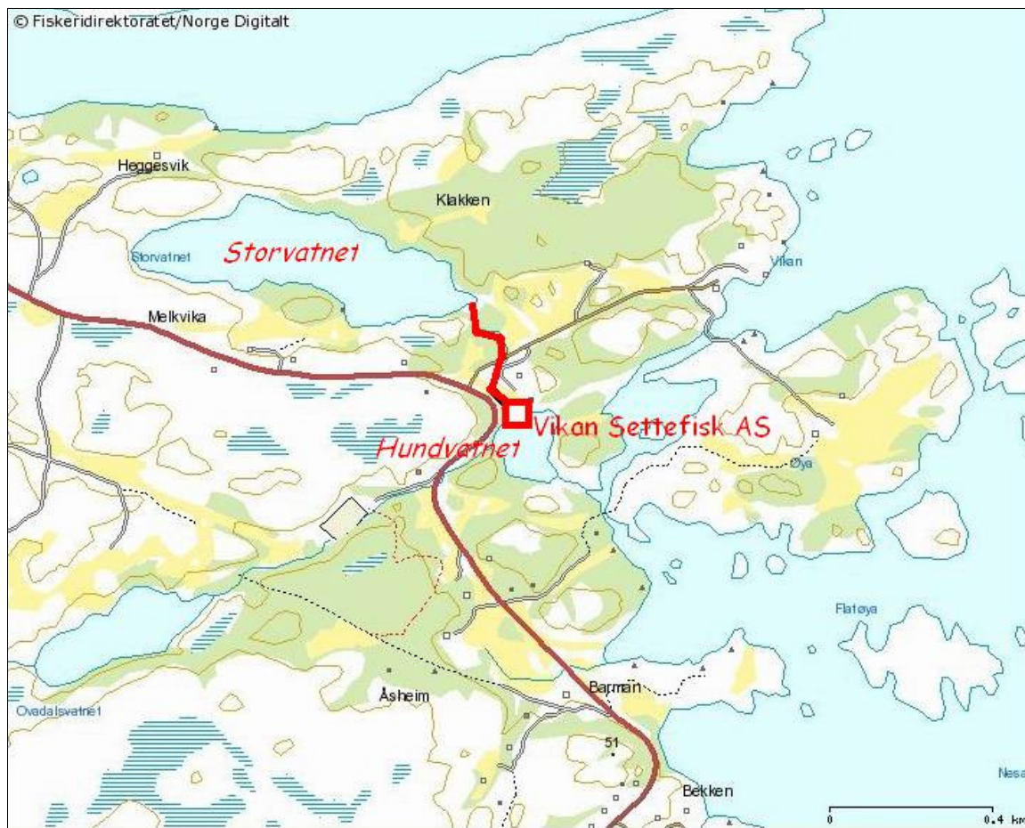
Figur 2. Vikan Settefisk AS sitt anlegg i Hitra kommune, med inntaksledning fra Storvatnet.
