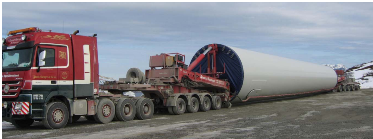
Figur 7-20: Eksempel på tung transport: nedre del av et turbintårn til Fakken vindkraftverk i mai 2012.
