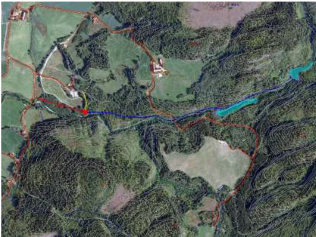
Figur 2 Flyfoto over området. Tiltaket er skissert inn på bildet. Kraftlinje mellom stasjon og trafo er merket rødt, mens vannveien er blå. De to damalternativene (A og B) er lilla avgrensninger. I tillegg er beregnet berørt areal oppstrøms dammene (inntaksbasseng) markert som lys grønn skravur.
