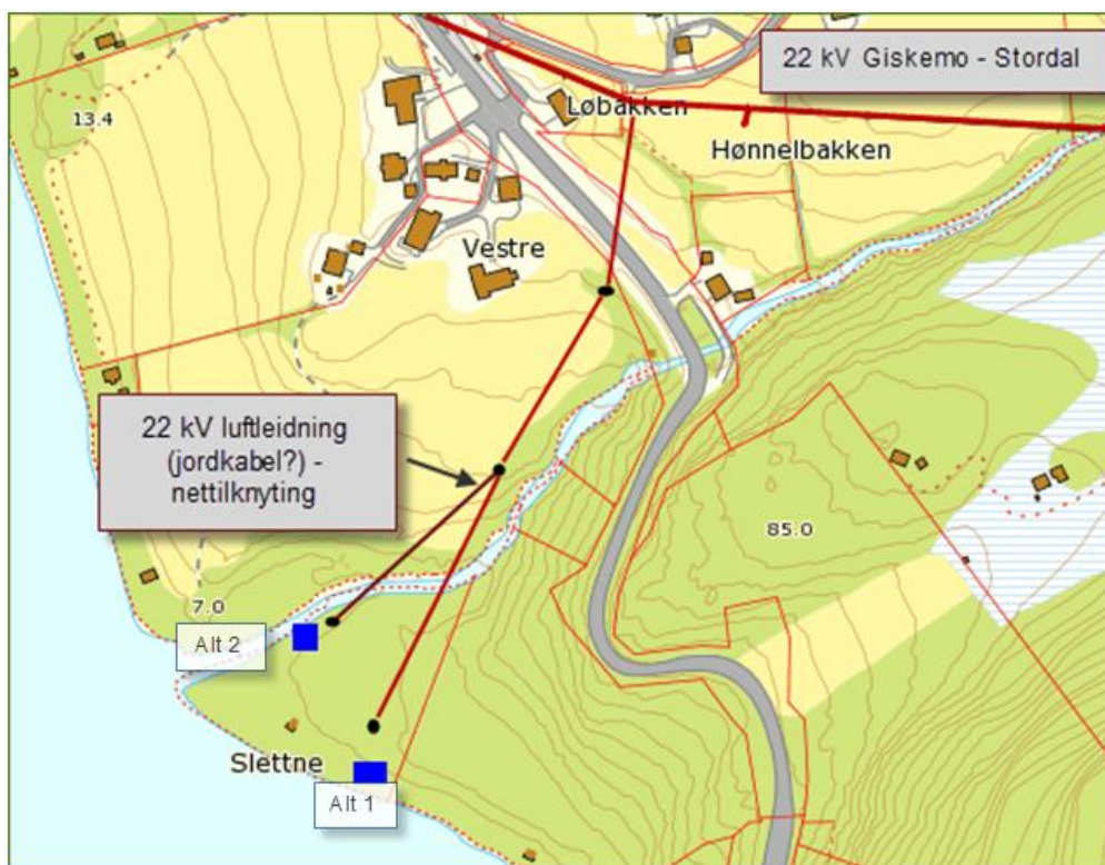
Figur 2.2.10.2 22 kV nettet og tilknytning av Vestre kraftverk.
