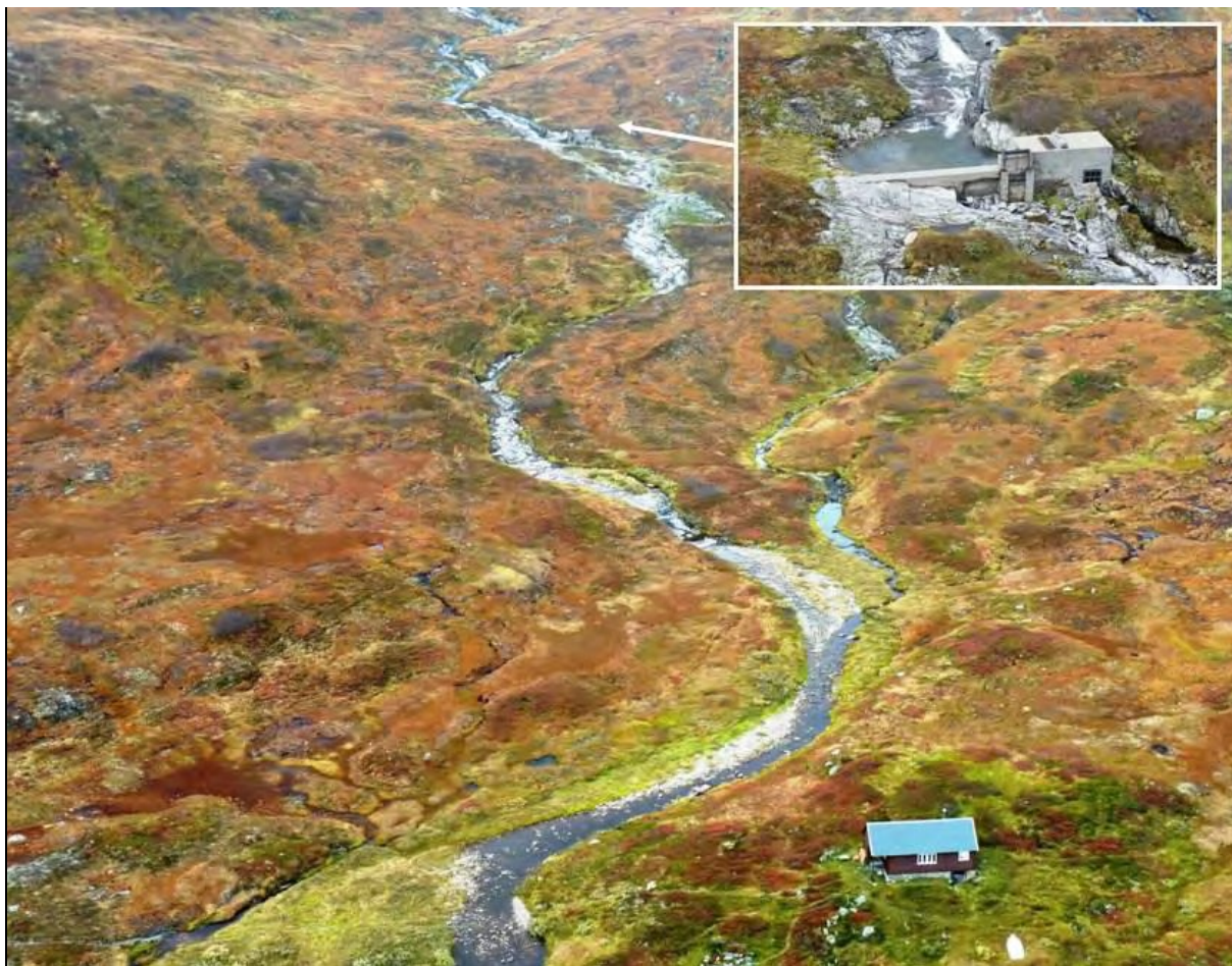
Figur 34. Blyfjellbekken rann tidlegare inn nedom Eitro bekkeinntak like oppi bakkenfor innløpet til Holmavatnet. No er feltet til Blyfjellbekken overført til inntaket.
