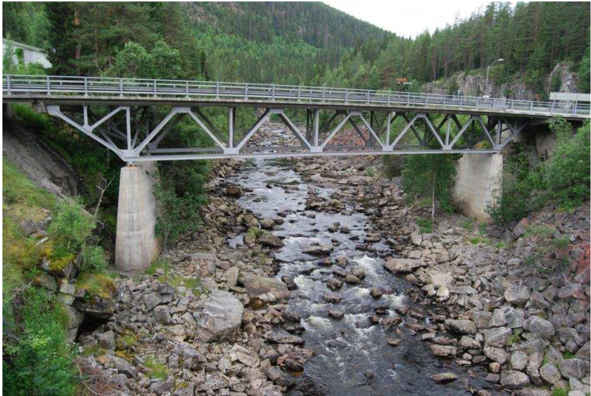
Målt 140 l/s sluppet fra Eikredammen. Lite resttilsig på grunn av tørt vær.
