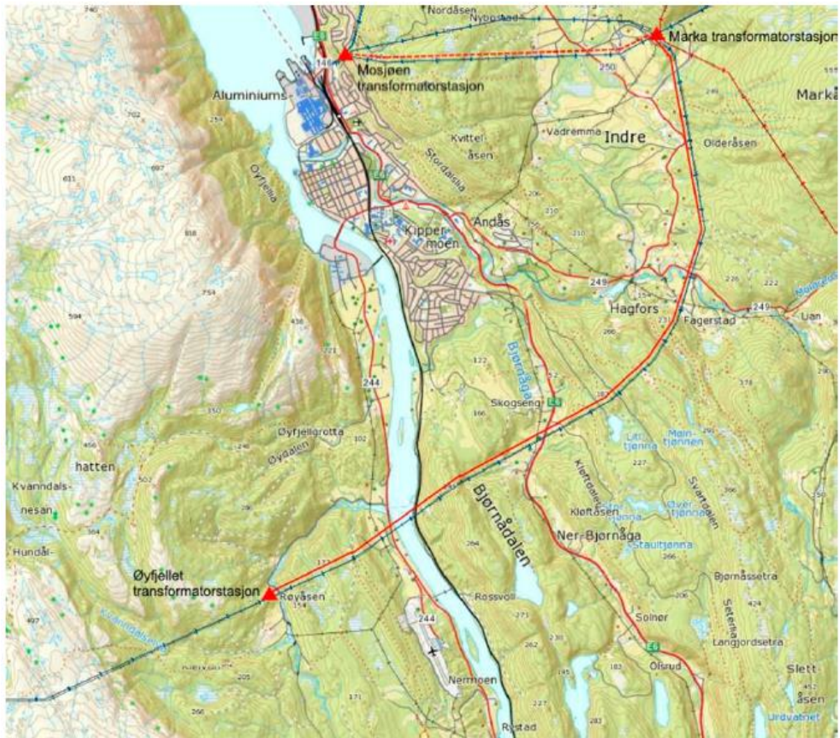
Figur 2. Konsesjonsgitt ny 132-kV-luftledning mellom Øyfjellet trafostasjon og Marka trafostasjon og plassering av Øyfjellet trafostasjon ved Tverråga gård. Kilde: Bakgrunn for vedtak. NVE 13.11.2014.
