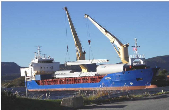
Figur 3-9 Lossing av vindturbiner ved Monstad kai. Kilde: TrønderEnergi Kraft 2008
