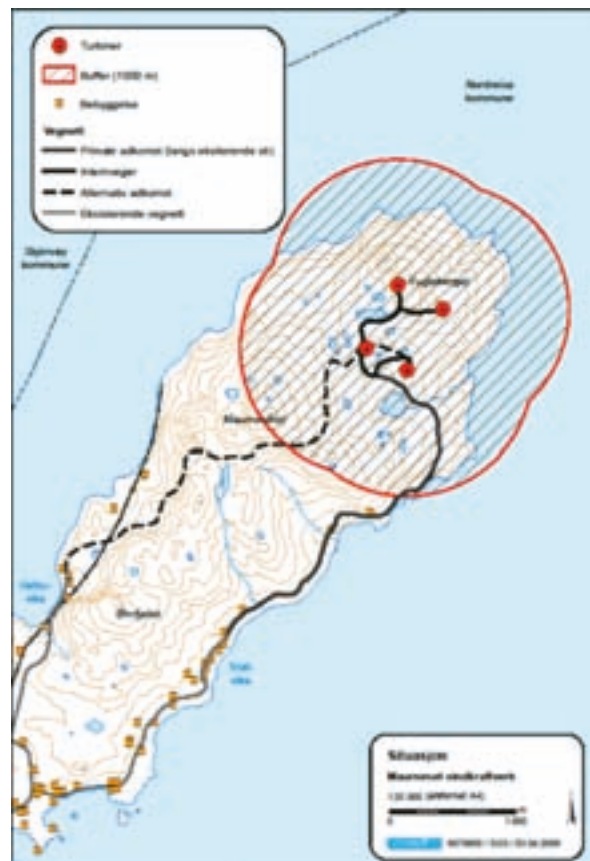
Figur 3. Situasjonsplan. Foreløpig plassering av vindturbiner på Maurneset.
