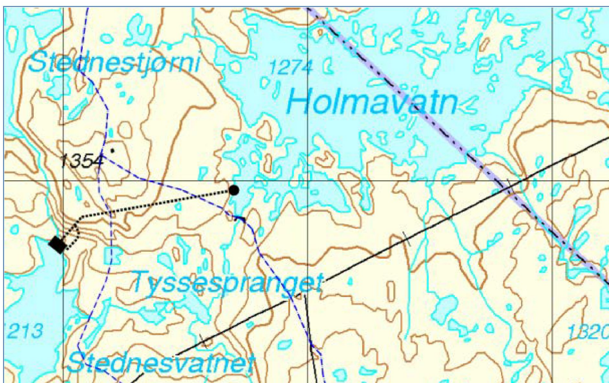
Figur 2. Inntak, tunnel og kraftstasjon for Tyssespranget kraftverk.
