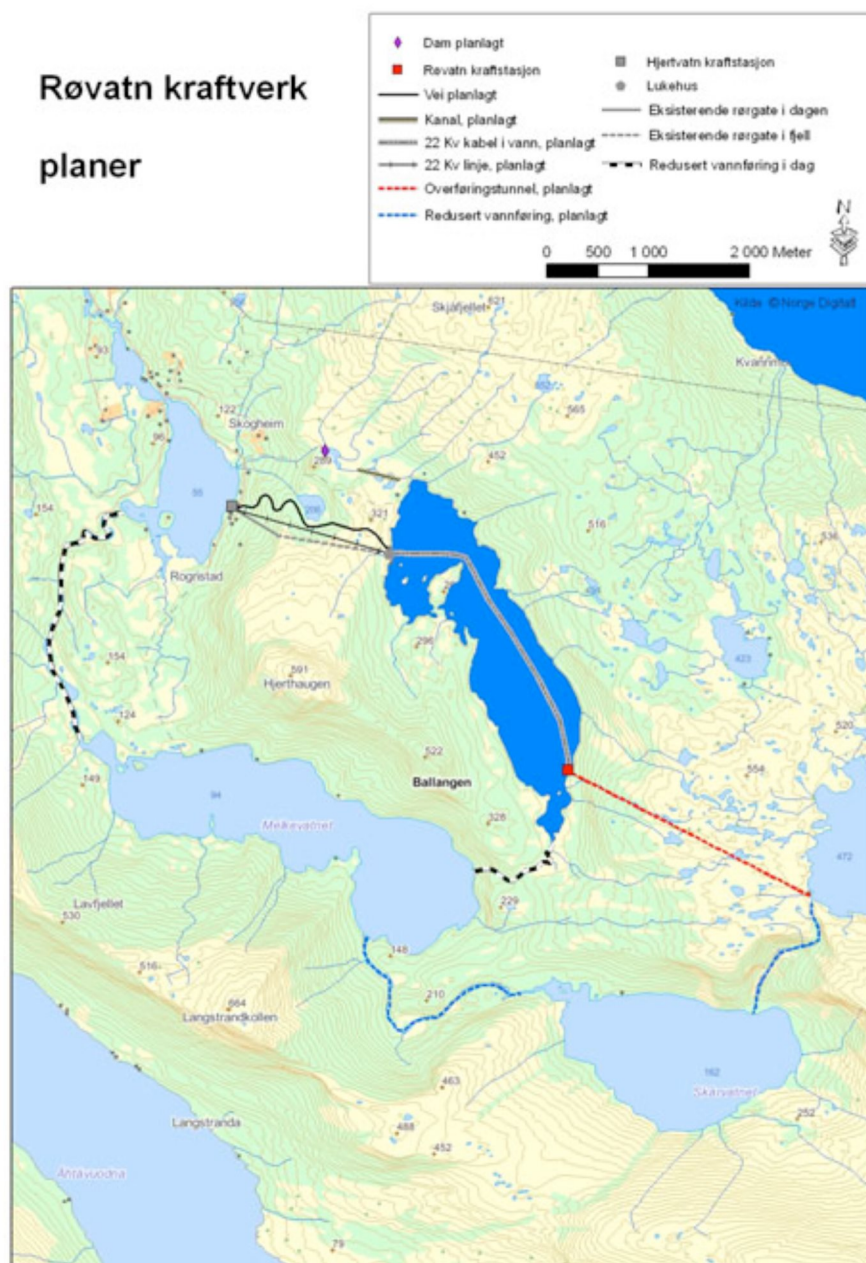
Figur 4.1 Planene for nytt Røvatn kraftverk inkludert overføringer.
