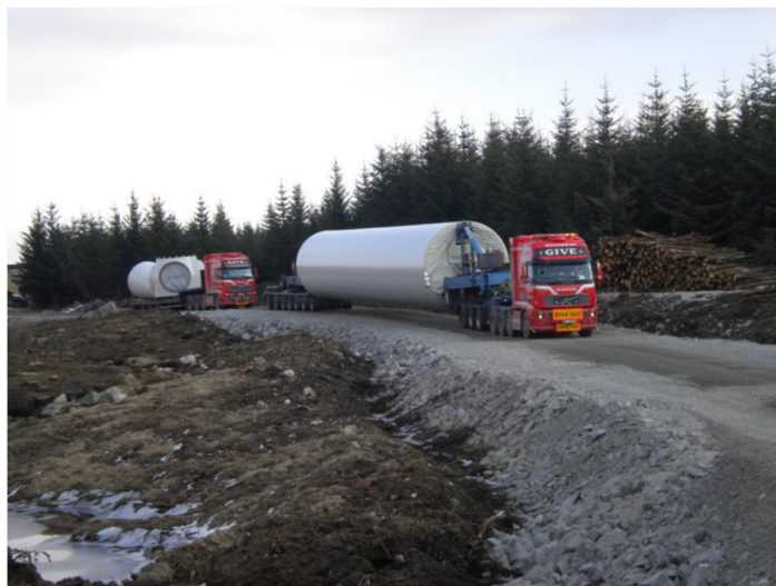
Figur 6: Transport av vindturbindeler
