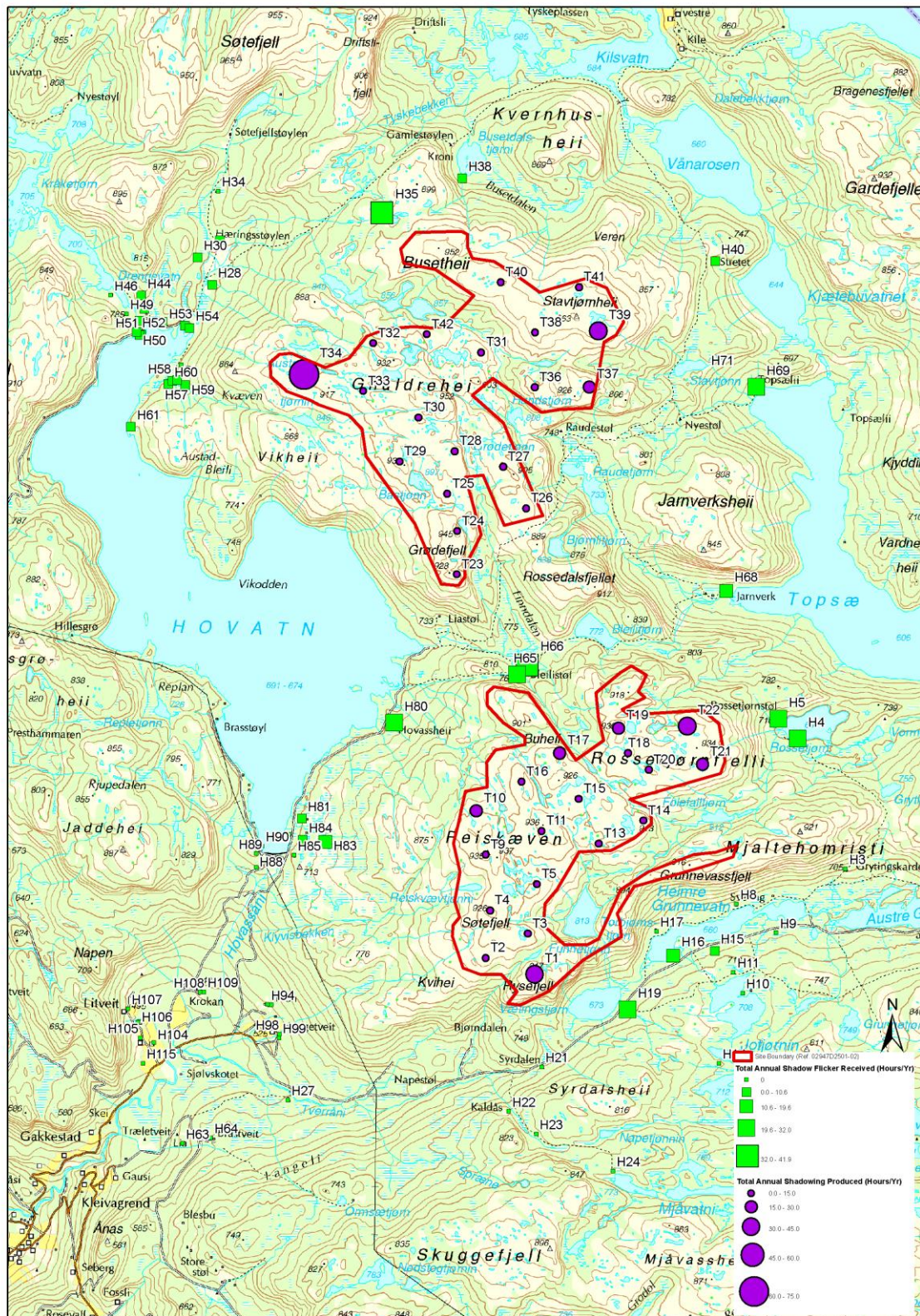
Figur 4.3: Teoretisk maksimalt årlig skyggekast for hver eiendom og varighet forårsaket av hver turbin
