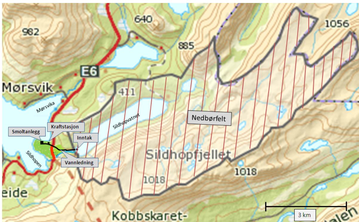
Fig 2: Nedbørfeltet til Sildhopvatnet er skravert. Omtrentlig beliggenhet er vist av inntak, vannledning, kraftstasjon og smoltanlegg. Kartet er basert på NVE Atlas. For mer detaljert kart, se Vedlegg nr. 4
