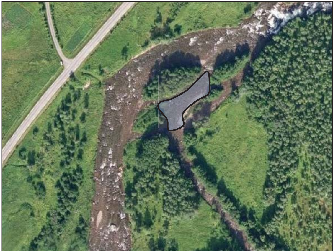
Bilde 5. Et mindre areal (ca. 900 m 2 ) i Skøelva som kun forsynes av vann fra Middagselva ved små vannføringer (markert som blått felt).
