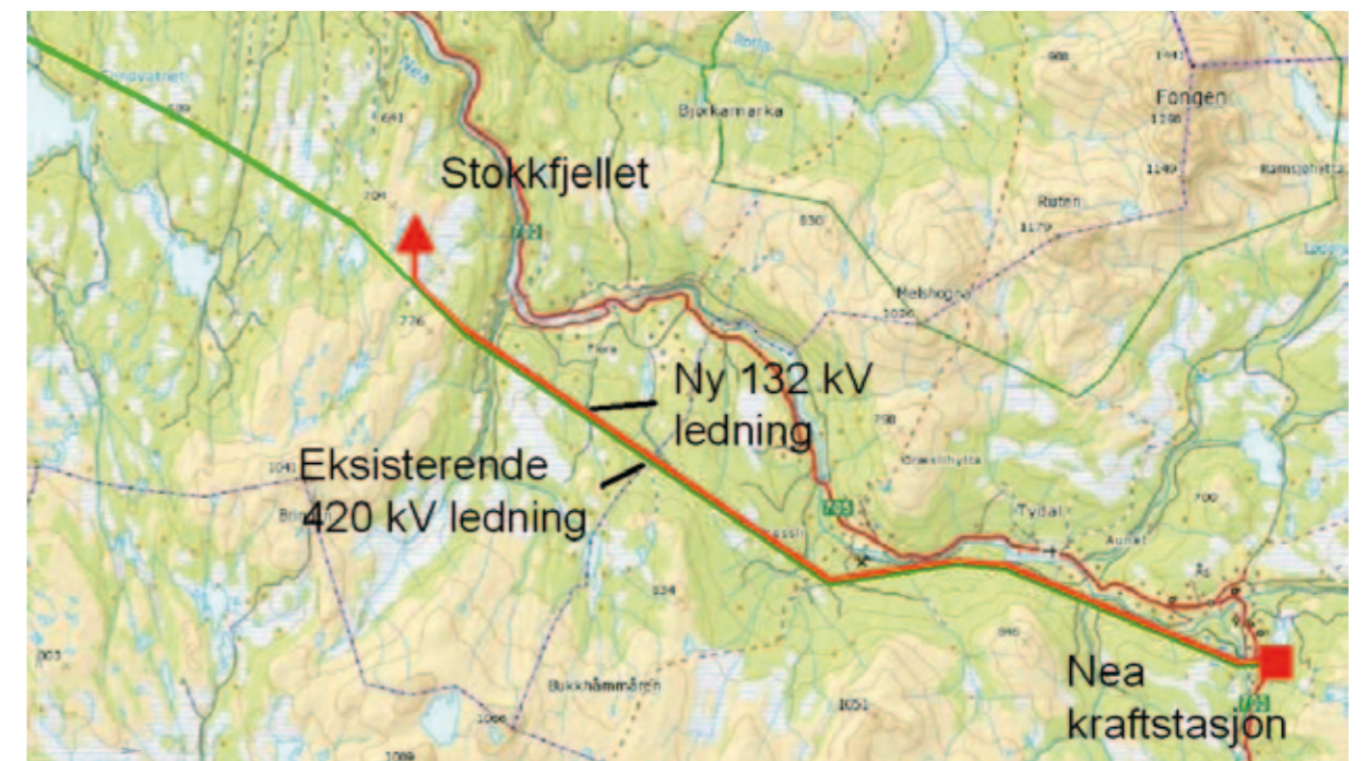
Figur 8. Nettilknytning av Stokkfjellet mot Nea kraftstasjon
