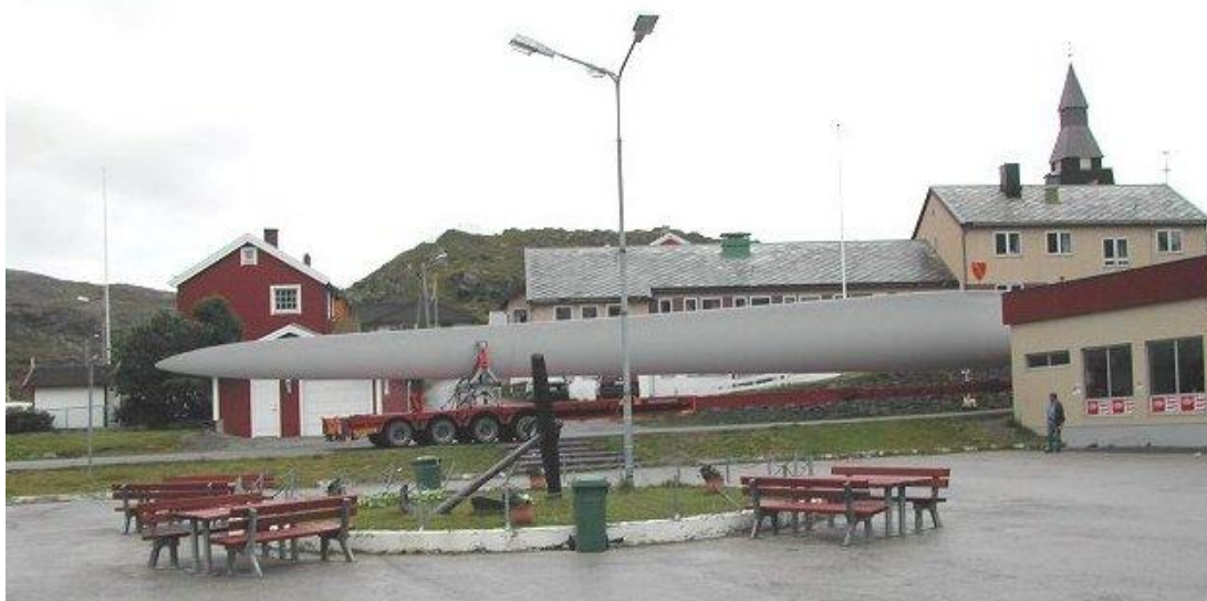
Figur 13.7 Rotorvinge transporteres gjennom Havøysund sentrum.
