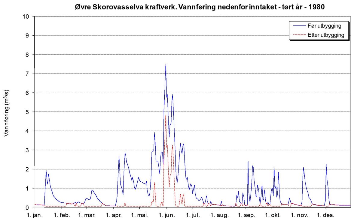
Figur 2: Vannføring i Skorovasselva like nedstrøms inntaket før og etter utbygging i et tørt år.
