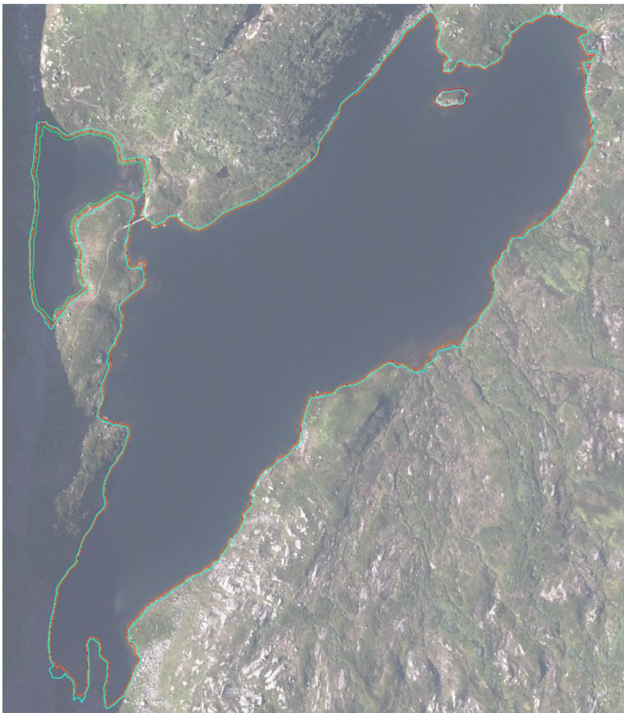
Figur 13 Kvalsdalstjørni med inntegnet LRV (grønn), LRV +0,5 m (rød) og HRV (LRV+1 m).
