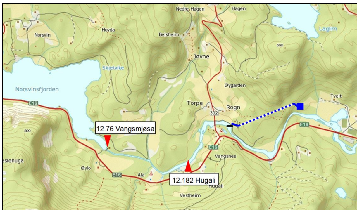
Figur 3. Føssaberge kraftverk utnytter fallet i Storåni mellom Rogn og Tveit. Kartet viser ellers plassering av målestasjoner for vannføring. Innsjøen Vangsmjøsa, til venstre, er regulert 3 m.
