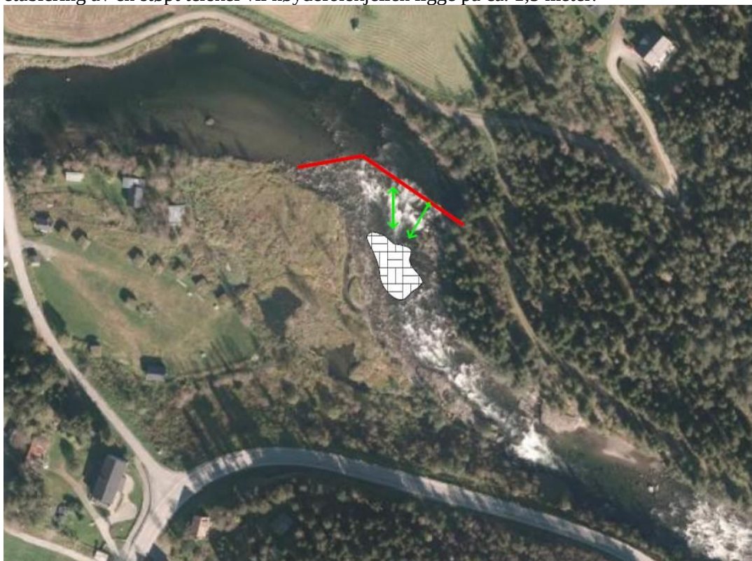
Figur 4. Rød strek markerer grov plassering av tenkt terskel. Grønne piler angir hovedvannstrømmen i området i dag.
