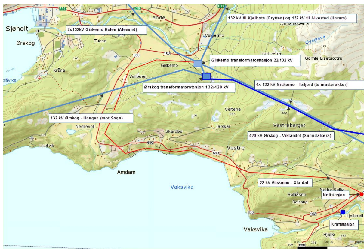
Figur 2.2.10.2 Nettbilde alle spenningsnivå mellom Kverve kraftverk og 420 kV sentralnett.
