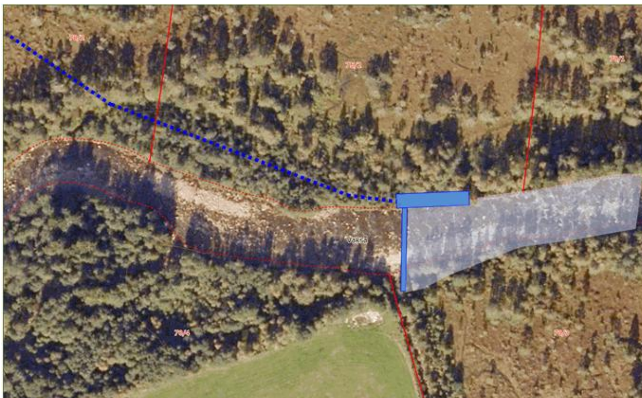
Figur 2.2.4.1 Inntak og omtrentleg neddemt areal (6000 m 3 ) vist på ortofoto.
