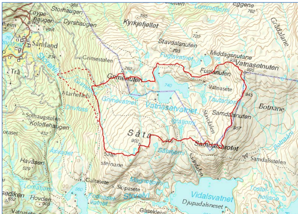
Figur 7: Kart over nedbørsfelt og restfelt mellom inntak og kraftstasjon
