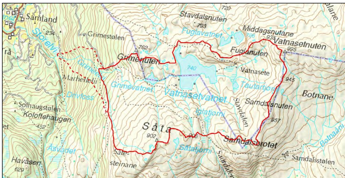
Figur 7. Nedbørfeltet til planlagt inntak og restfelt for Grimeelvi kraftverk (kilde: Scanergy Vannkraft).
