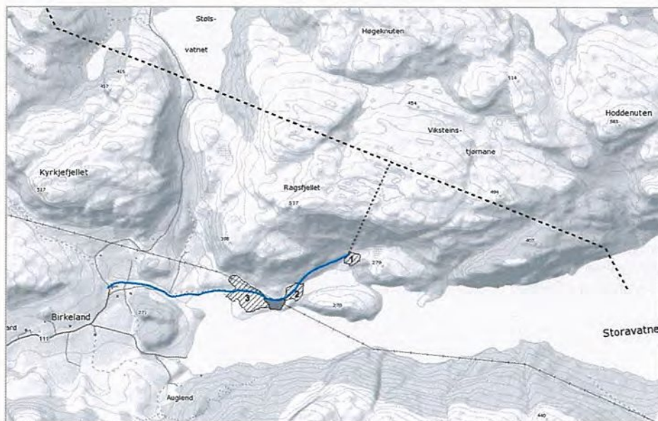
Figur 2. Skisse som viser det omsøkte tiltak. Ny veg (blå strek), deponier (1, 2 og 3), rigg og anleggsplass (mørk grå), samt tunnel (stiplet strek) for adkomst og råvannstransport frem til eksisterende anlegg.
