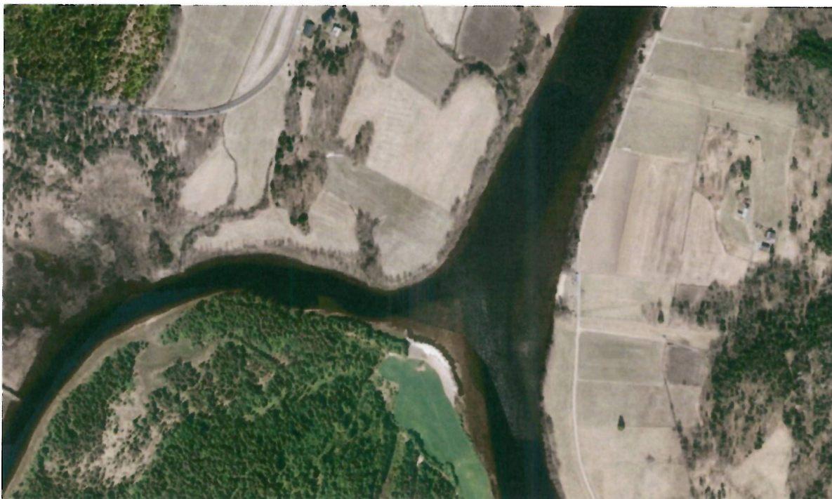
Figur 2.3 Bjorsundet ligger i en yttersving i Nidelva. Sandbanken som er bygget opp i «pålandsodden» til Bjorsund bidrar til å sende en betydelig del (anslagsvis 1/3) av vannføringsøkning i Nidelva inn i Rore bare som følge av vannets bevegelsesenergi. Men oppstuing i trange sund i Nidelva like nedenfor Bjorsund, er nok den viktigste årsaken til innstrømning. Foto: Statens kartverk
