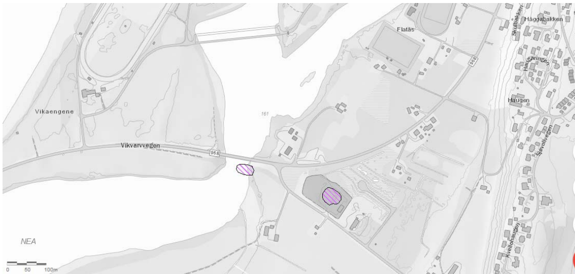
Figur 3: Områder med påvist kvikkleire fra SVVs grunnundersøkelser ved utløpet av Nea. (NVE Atlas)
