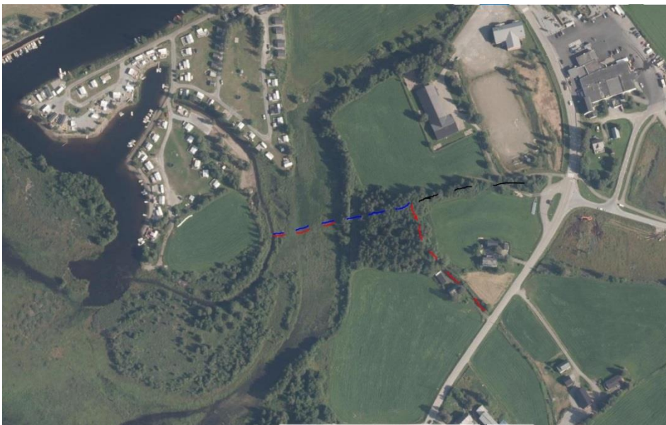
Figur 2-50 Rød stipling er tidligere sikret kanal, blå stipling er forslått tiltak med senking av eksisterende kanal og blå-rød stipling er ny kanal over til nyere utgravd kanal fra campingplassen. Flyfoto 2017.
