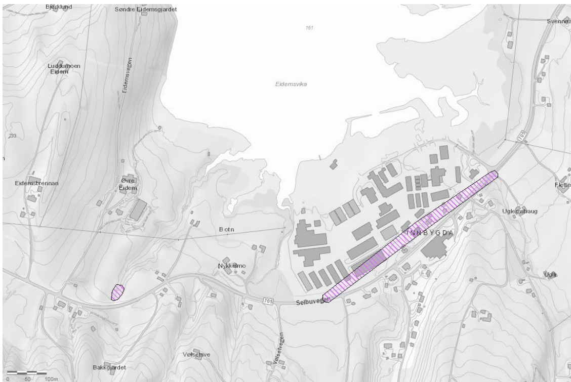
Figur 2: Områder med funn av kvikkleire fra SVVs grunnundersøkelser ved Innbygda/Eidemsbukta. (NVE Atlas)
