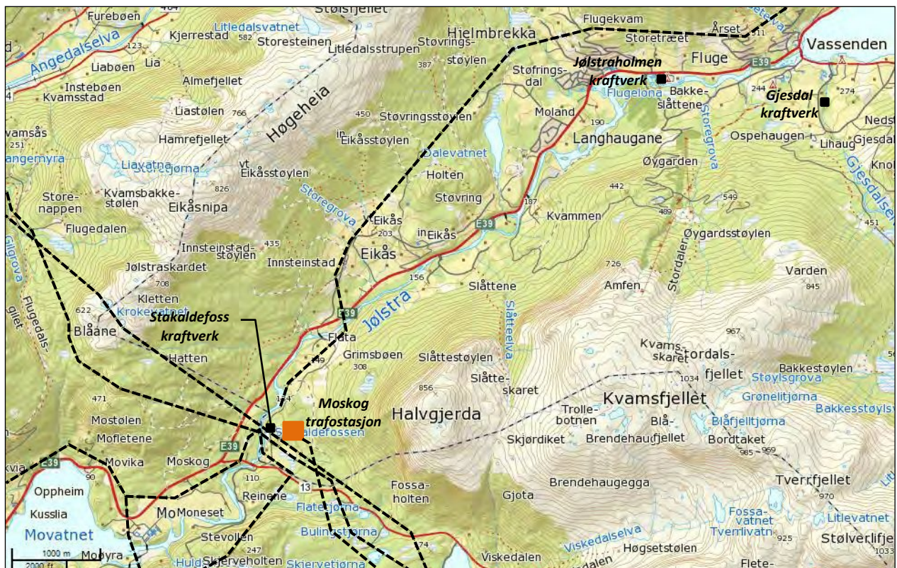
Figur 2 Kart over tiltaksområdet med kraftlinjer (stiplet) og nye Moskog transformatorstasjon markert.
