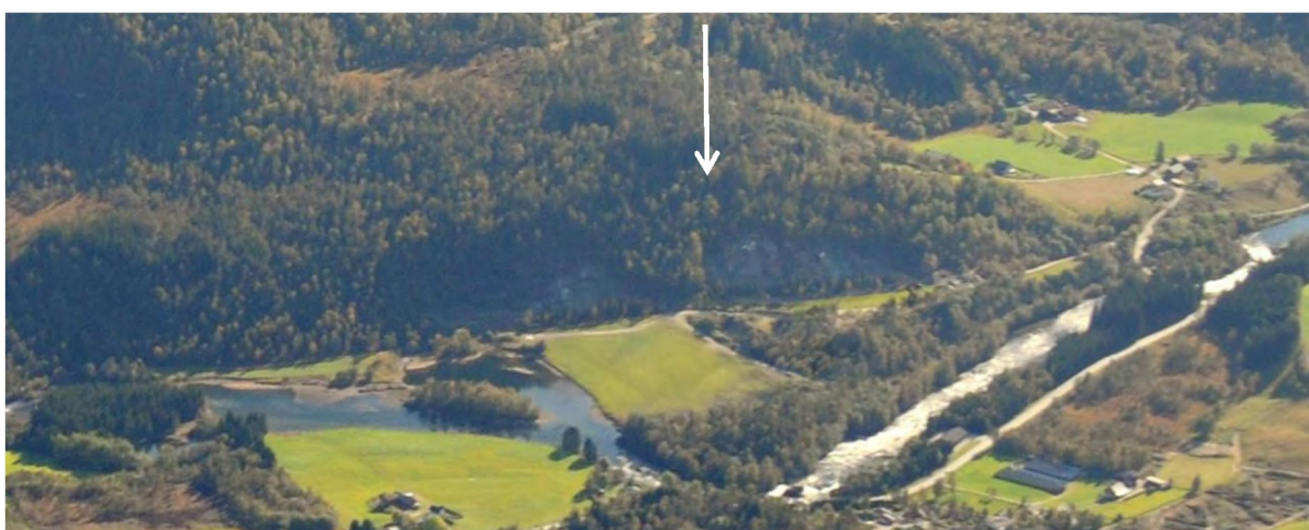
Figur 2.16 Redigert foto som viser at de gamle masseuttakene (1) er fylt igjen med masse fra tunnelene. Med tiden vil de flateste partiene ned mot vegen fremstå som grønne og som en integrert del av landskapet.
