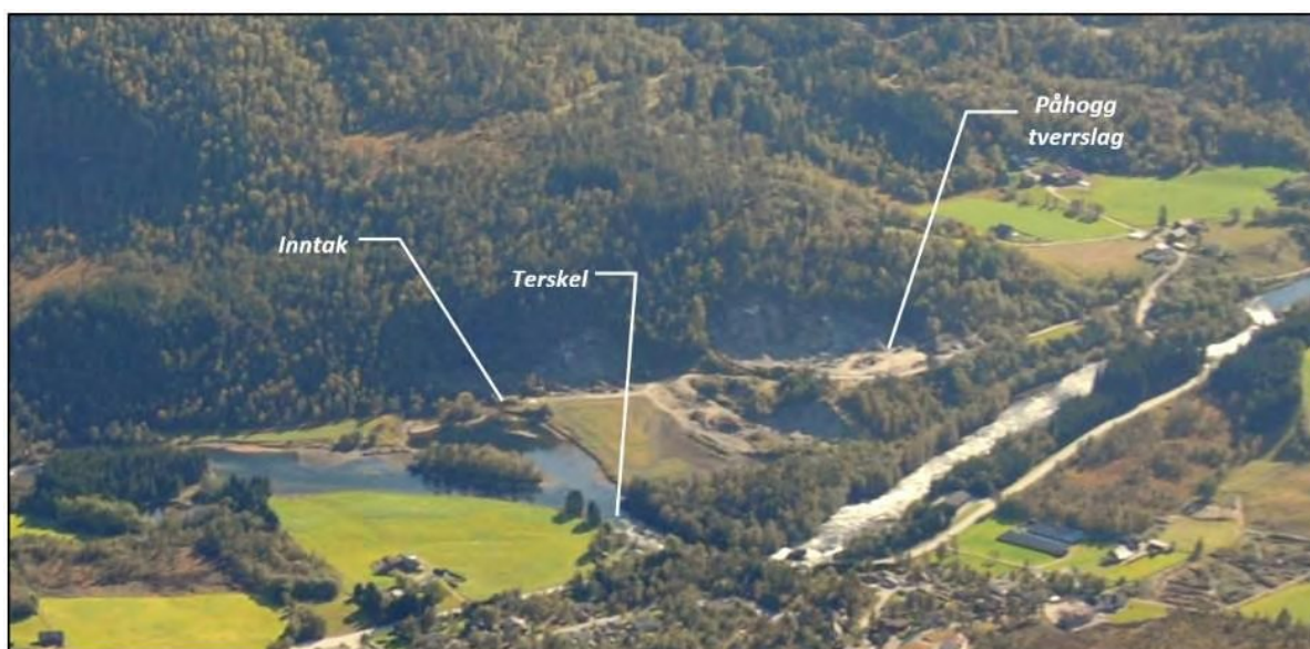
Figur 4. Inntak, terskel og mogleg påhogg for tverrslag ved Tongahølen.
