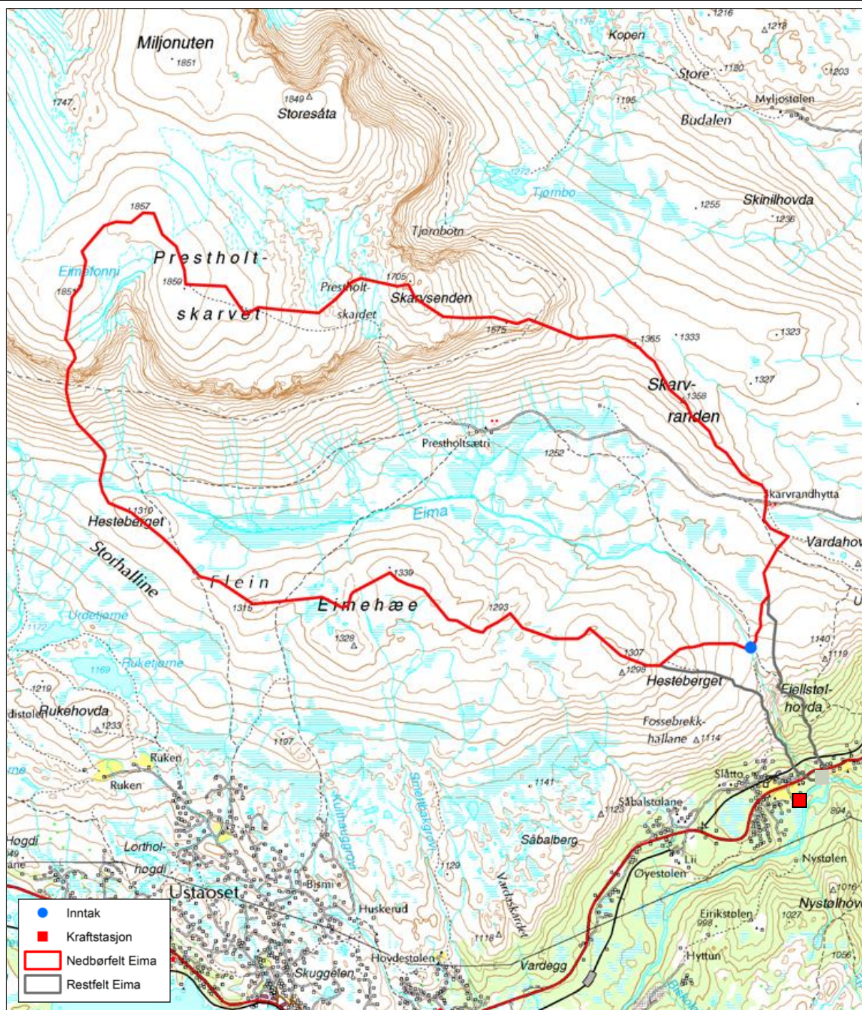
Fig. 4. Eima med avgrensning av planlagt utnyttet nedbørsfelt samt restfeltet mellom inntak og stasjon. Kartkilde: Tiltakshaver.
