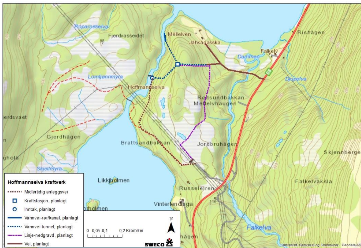
Figur 1: Prosjektområdet ved Hoffmannselva kraftverk påtegnet utbyggingsplaner. Bakgrunnskart GeoData og GeocacheLandskap, via ArcGis 10.2.1..
