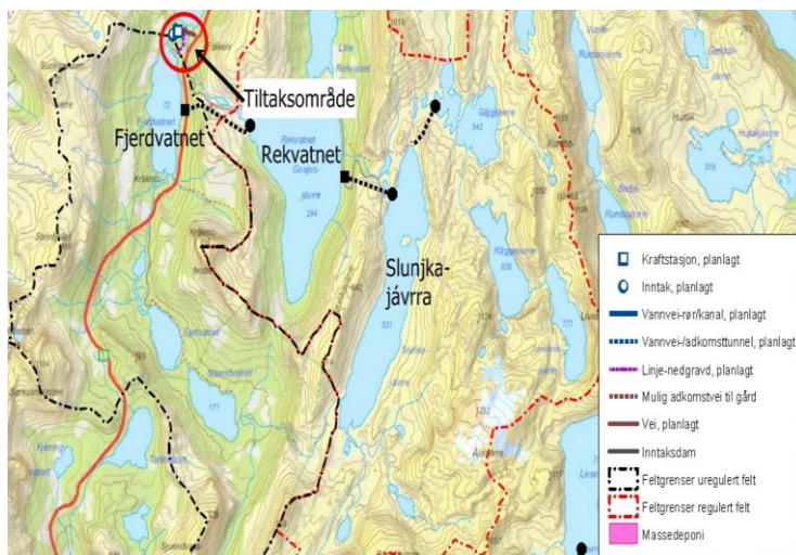
Figur 2. Nedbørsfeltet til Hoffmannselva består av to delfelt. Delfeltet til høyre (røde grenser) er delvis overført til Fjerdvatnet og har blitt utbygd/regulert for kraftproduksjon i flere omganger. Delfeltet til venstre (sorte grenser) er uten vannkraftverk i dag, men det er gitt konsesjon til Femtevassselva kraftverk (2010). Vann som opprinnelig var i delfeltet (t.h.) overføres nå fra Slunjka-jávrra til Rekvatnet.
