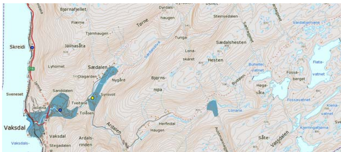
Figur 11 Grunnvannspotensiale i Vaksdalsvassdraget avmerka med blå felt (Kilde: NGU)
