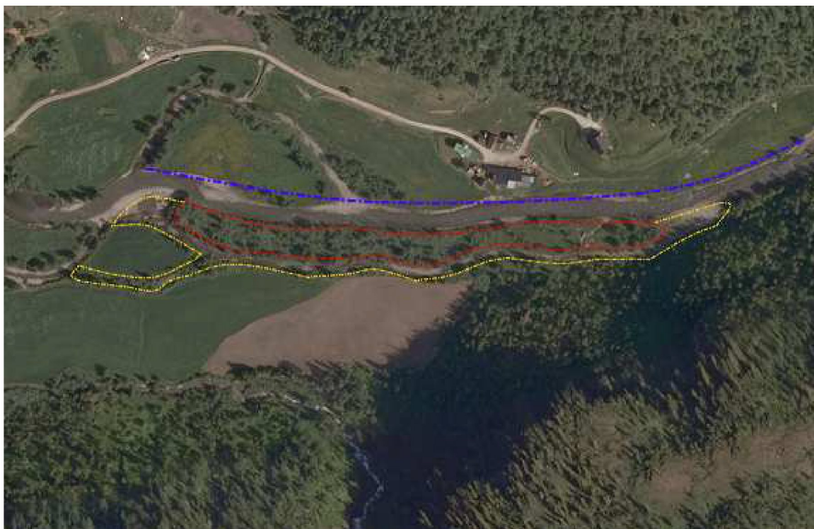
Bilde 12 – Plan over deponi langholmen. Rødt område ~7000 kvm, gult område ~6000 kvm. Blå linje viser tenkt flomsikringssone og utvidelse av elva for å kompensere for flomløpet i gult område.
