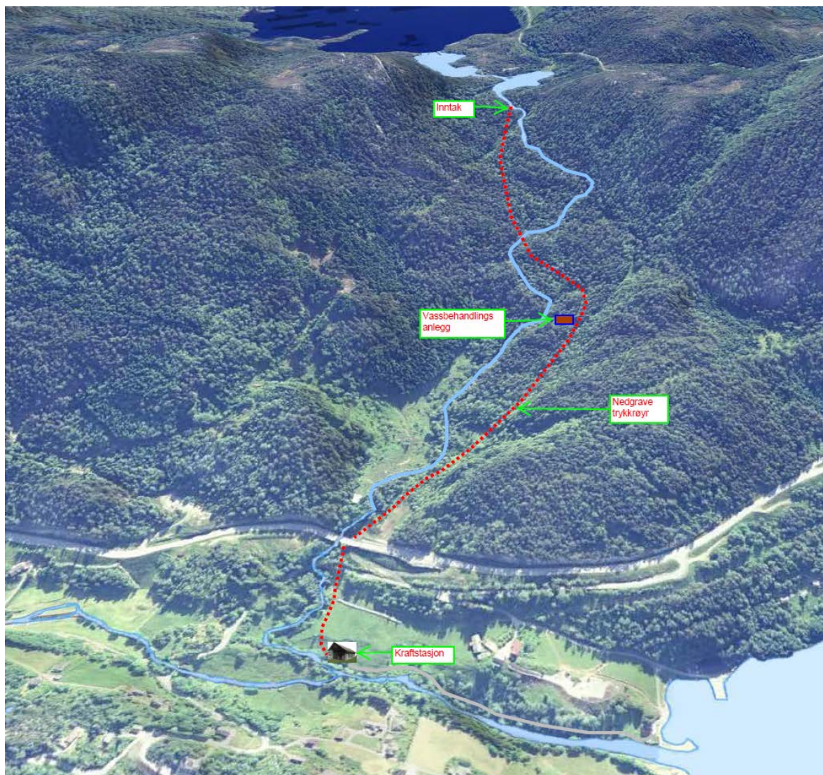
Bilete 2.2.5.1: Terrengmessig plassering av røyrgate.
