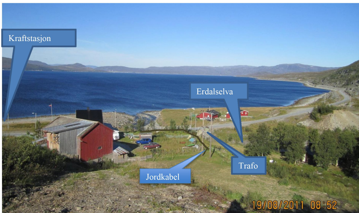
Figur 6. Forslag til plassering av tilknytting til kraftnettet
