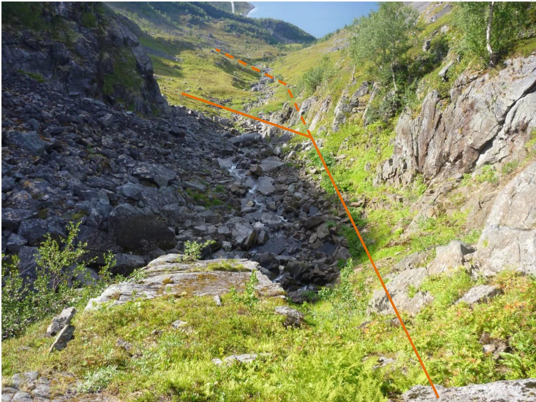
Bilde 4: Hamnaelva sett nedstrøms. Rørtrase` med alternativ trase indikert (k.320 - 270).
