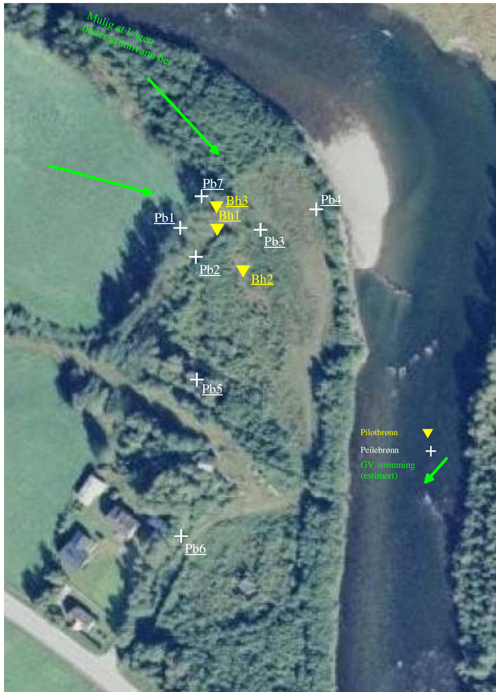
Figur 3 Borepunkter og antatt regional grunnvannsstrømning mot brønner (Bh1 og Bh3), Dovreskogen.
