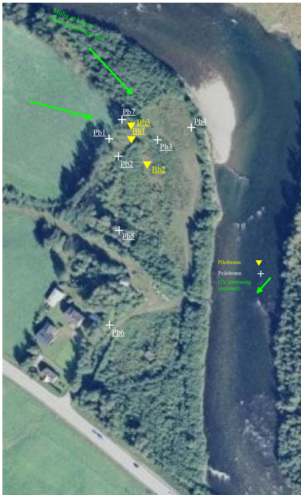
Figur 1.3 Borepunkter og antatt regional grunnvannsstrømning mot brønner, Dovreskogen.
