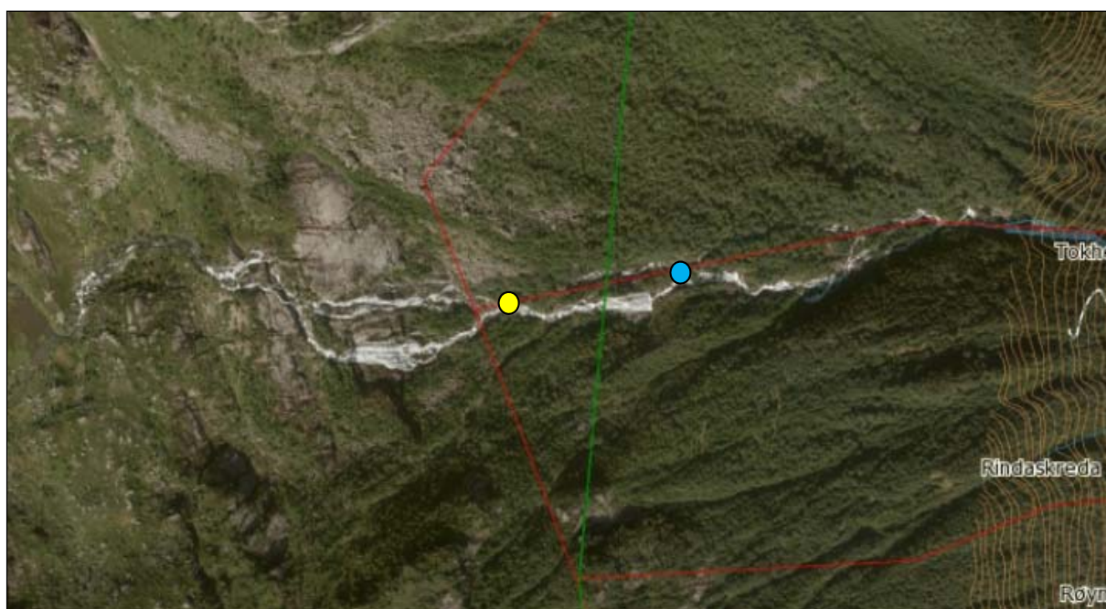
Figur 25: Blå sirkel markerer hovedalternativ for inntak ved høydekote 540 m. Gul sirkel er alternativ for inntak ved høydekote 640 m. Begge inntakene ligger nedenfor det største fossefallet i Tokheimselva.
