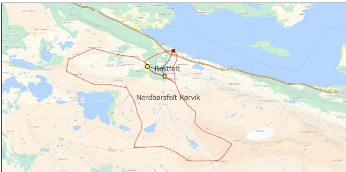
Figur 4. Nedbørfelt og restfelt til planlagt Rørvika kraftverk.
