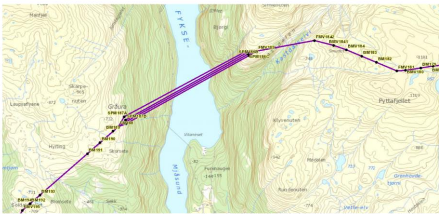
Bilete 2 Trasékart for kryssinga av Fyksesundet med 420 kV-kraftlinje Sima-Hardanger. Kjelde: Statnett.
