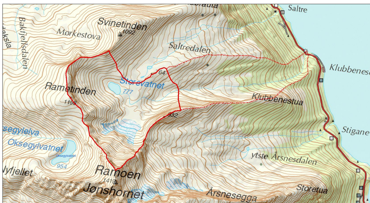
Fig. 3. Avgrensning av nedbørsfeltet knyttet til prosjektet i Klubbeneselva. Nyttbart nedbørsfelt er beregnet til 1,35 km 2 . NVE-Regime nr: 097.111. Kilde: Småkraft as.
