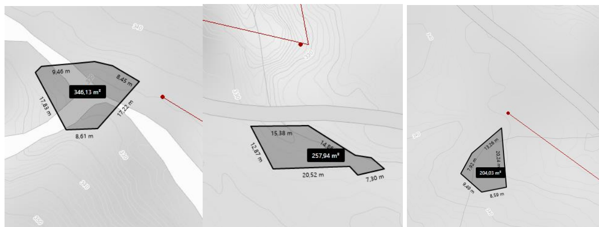
Figur 26 Visualisering av inntak 1, 2, og 3 visualisert med oppdemt areal
