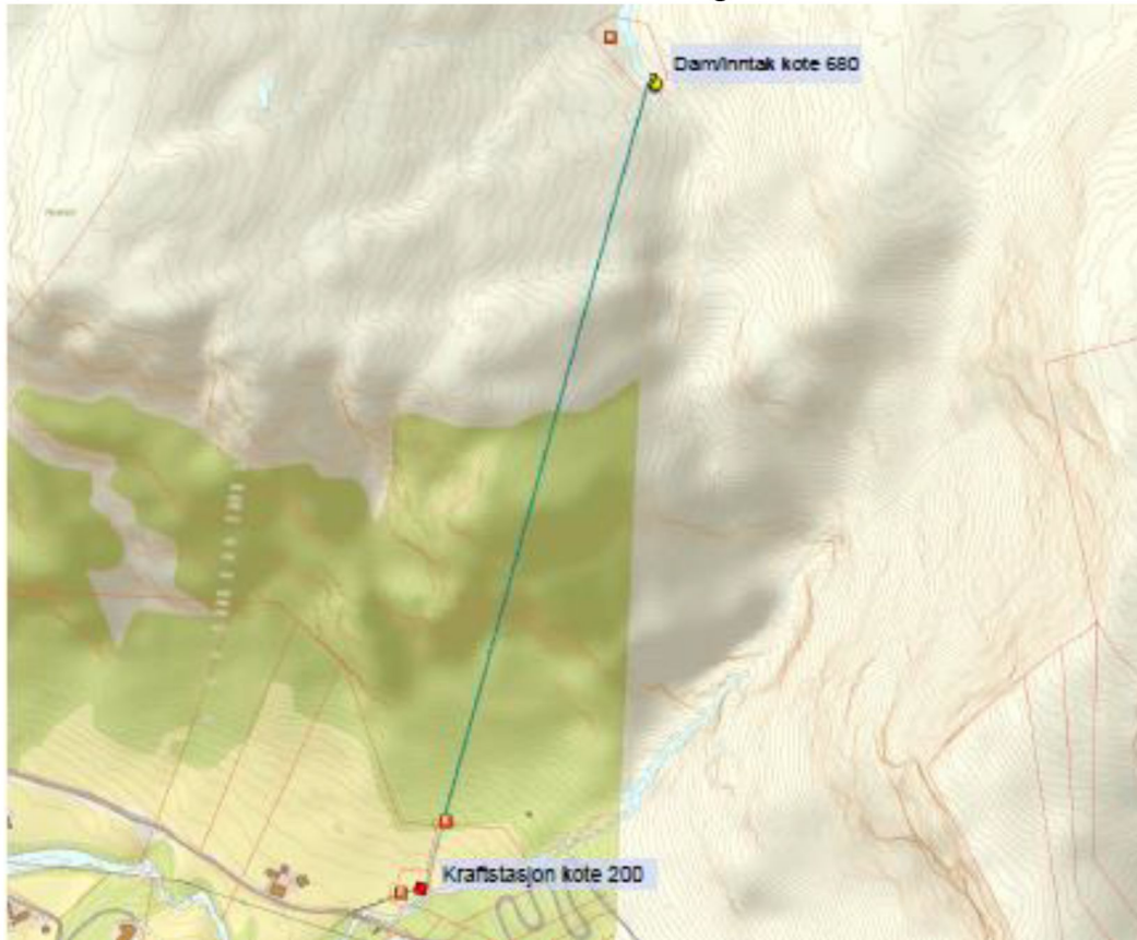
Figur 10 Vannvei fra inntak til kraftstasjon
