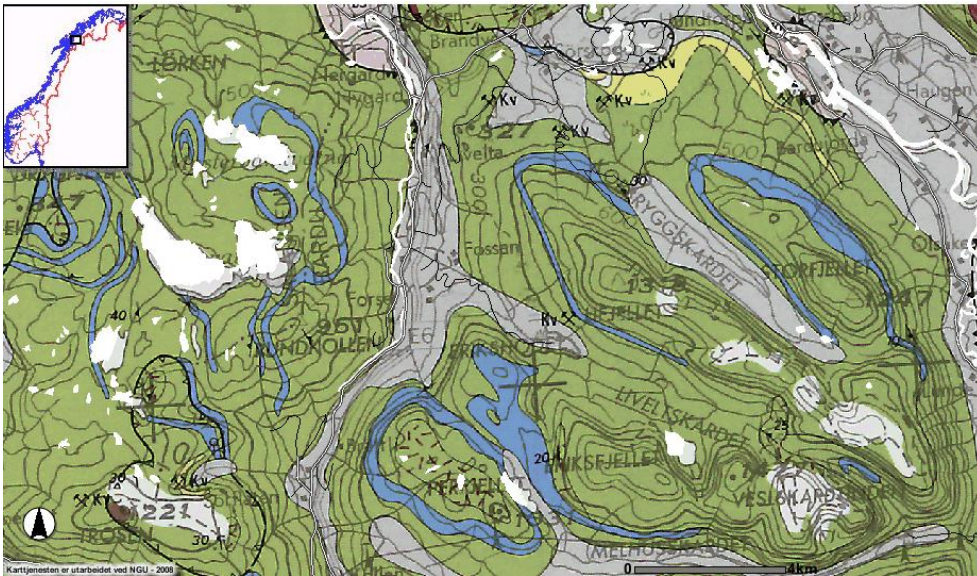
Figur 4.2 Berggrunnskart over arealene sør for Setermoen i Bardu kommune, der undersøkelsesområdet ligger sentralt i kartutsnittet. Den lysegrå fargen i dalbunnen er løsmasser, mens blått er kalkspatmarmor og olivengrønn farge glimmerskifer og glimmergneis. Trolig stemmer kartet nokså dårlig med situasjonen i undersøkelsesområdet, jfr kommentarer i teksta. Kilde: Norges geologiske undersøkelse 2008 ( www.ngu.no/kart/bg250/ ), basert på Zwaan et al. (1998).
