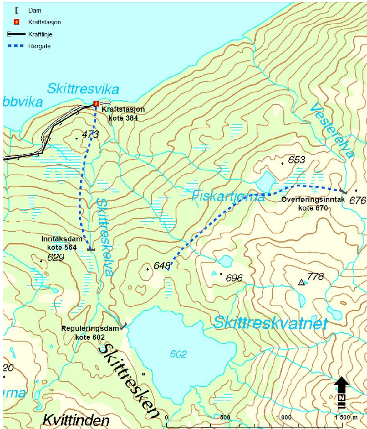
Kart 3: Teknisk plan for Skittresken kraftverk.
