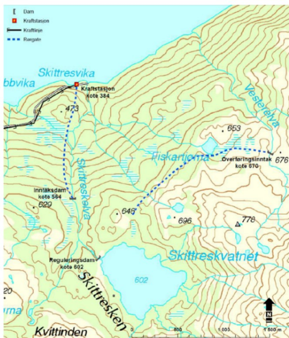
Figur 1. Teknisk plan for Skittresken kraftverk.
