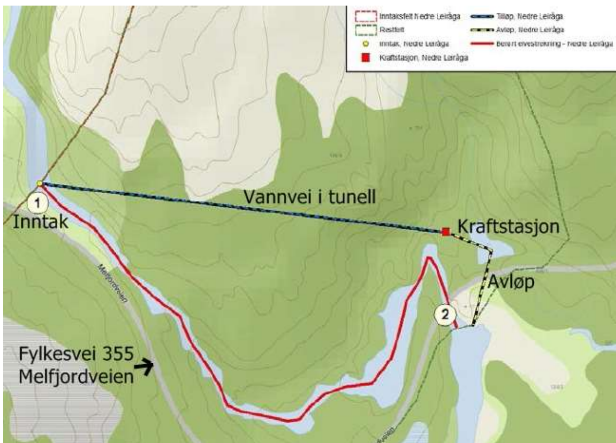
Figur 3 Oversiktskart over planlagt kraftverk (fra konsesjonssøknad). Berørt elvestrekning vises med rød strek.
