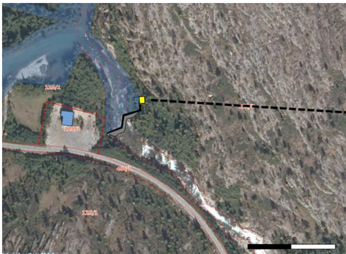
Figur 2-4. Melfjordveien brottestasjon, planlagt dam, inntak og tunneltrase.
