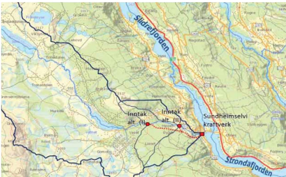
Figur 1: Viser plassering av inntak, rørgate (rød stiplet linje) og kraftstasjon for Sundheimselvi kraftverk alternativ 1 og 2. Kart mottatt av Skagerak Kraft AS. Situasjonsskart for alt. 1 og -2 er vist i vedlegg 3 og 4.
